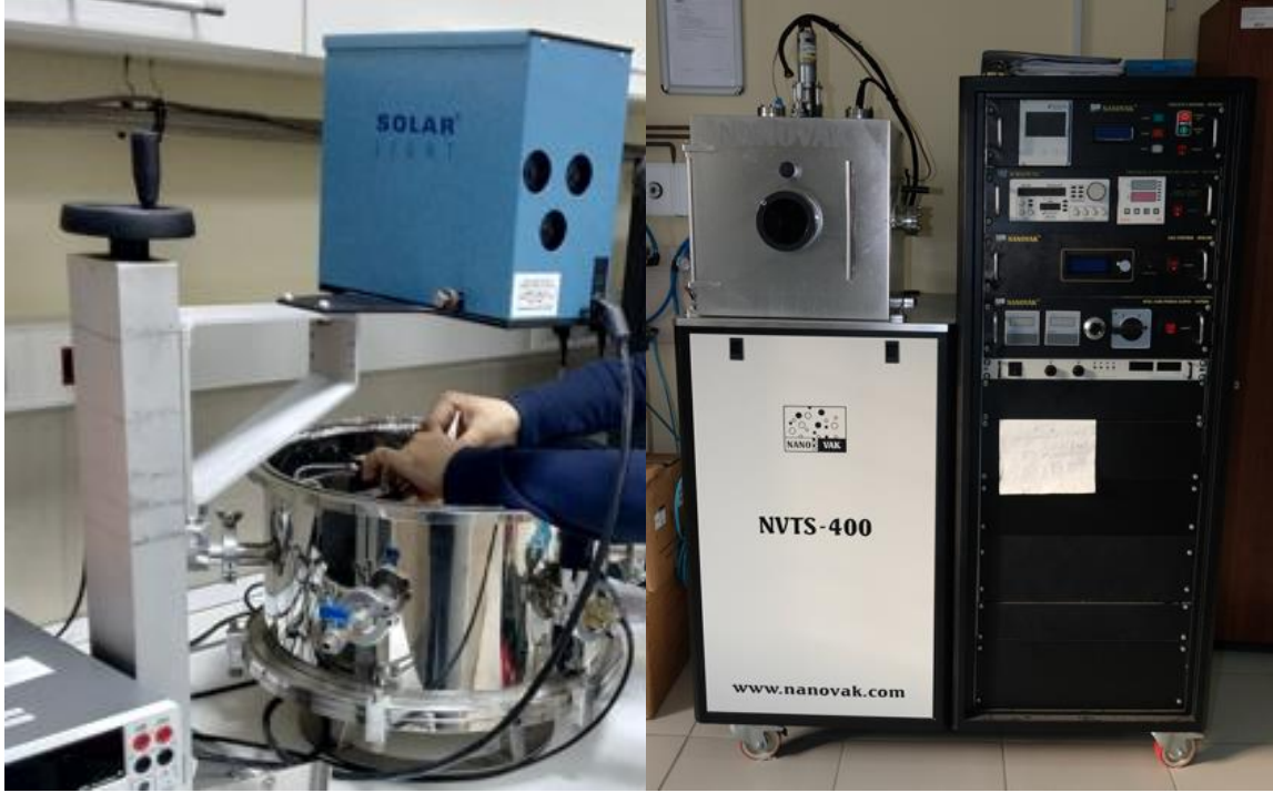
Görsel 4. a) Güneş simülatörü cihazı ve b) NANOVAK NVTs-400 vakum cihazı
